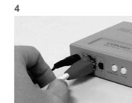
Link Cat.5 cable
